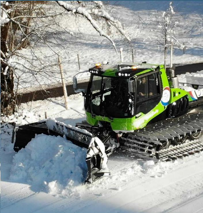
Die Präparierung der WM Anlagen mit dem PistenBully 600 E+ setzt neue Maßstäbe für einen nachhaltigen Loipenbetrieb. Die Fahrzeuge führen durch ihren diesel-elektrischen Antrieb zu wesentlich geringeren Emissionen und Motorengeräuschen.
