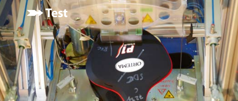
Beim Schlagtest stürzte der Fünf-Kilo-Amboss aus einem Meter Höhe auf die Protektoren.
